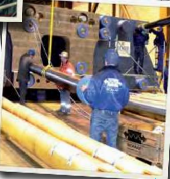
ЭхраТен в плите прессы дляковки в открытом штампе размером \varnothing 270 \times 6700 мм
