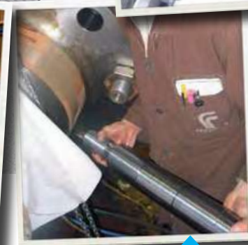
ЭхраТен с 2 коническими втулками для гребного вала корабля
