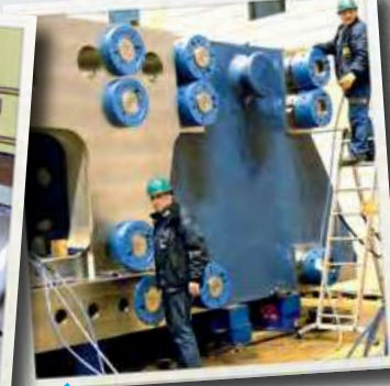
Сквозное соединение металлических деталей с помощью ЭхраТен в плите прессы дляковки в открытом штампе
